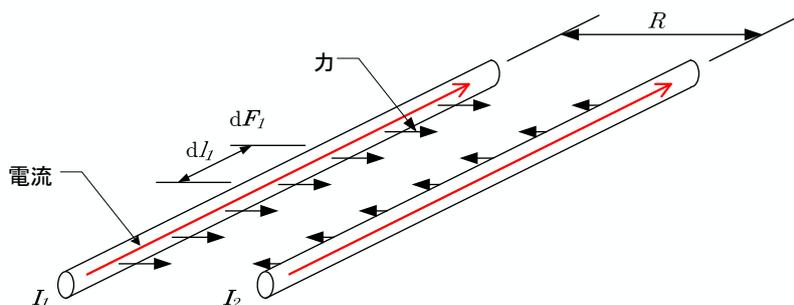
図 5: 電線間に働く引力
