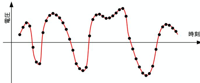
図 2: アナログ信号をサンプリングを行い , データをデジタル化している . 等間隔の時刻で測定した電圧が記録される . また , 電圧も特定の電圧間隔で測定している . この電圧を記録したものがデジタルデータである .
