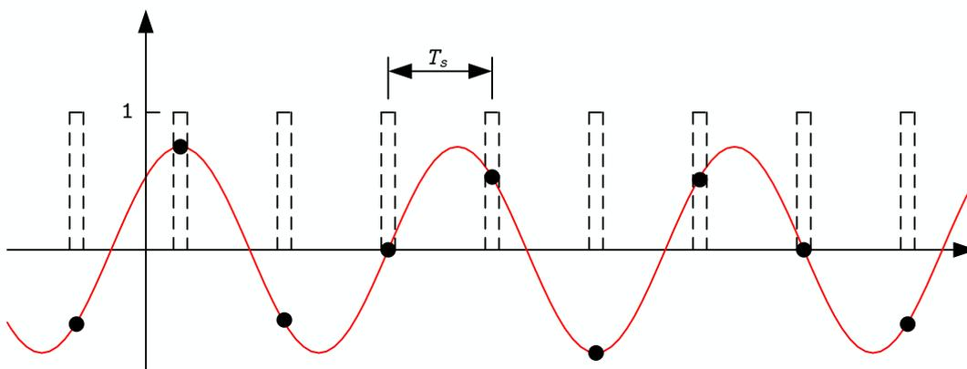
図 5: 実線が実際の信号で、点線の矩形がサンプリングを取り出す関数である。
