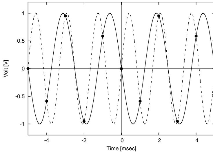
図 4: エイリアシングの例．点線が実際の信号 (0.6[kHz]) で、それを 1[KHz] でサンプリングした． がサンプリングの結果である．サンプリングの結果は、実線で表した 0.4[kHz] の信号と一致する．
