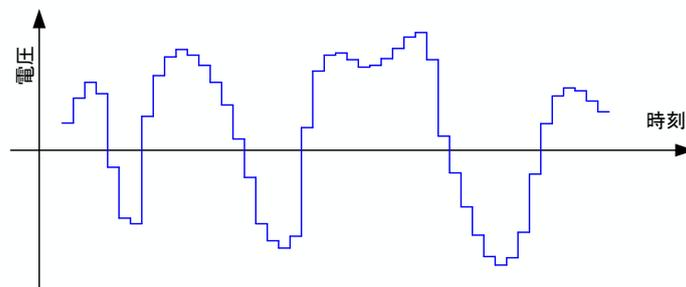
図 3: デジタルデータから元の信号を再構成する .
