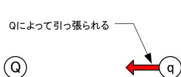
図 1: 電荷  $q$  に及ぼされる遠隔作用
