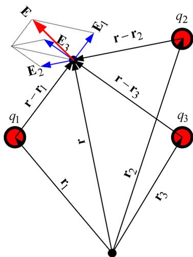
図 5: 点電荷がつくる電場の重ね合わせ
