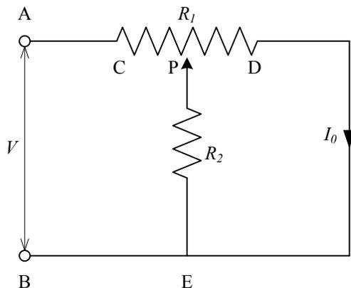
教科書にならい CP 間の抵抗を  $X$  とする。すると、PD 間の抵抗は  $R_1 - X$  となる。あとは、キルヒホッフの法則を使えば計算できる。左の回路に流れる電流を  $I_1$ 、右の回路に流れる電流を  $I_0$  とする。すると、以下の連立方程式
