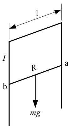
導線  $a, b$  が一番上にあるとき  $x = 0$  とする座標を選び、下に向かうとそれが増加するようにする。すると回路が囲む面積  $S$  は、 $x\ell$  となる。ここを貫く、フラックスは  $\phi = x\ell B$  となる。抵抗は、導線  $a, b$  のみなので、その間の電圧は、
