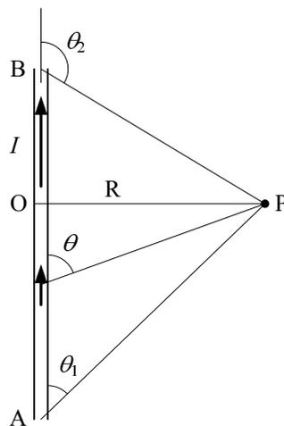
点 O から直線電流に沿った座標を  $x$  とする．A の方向が負で B の方向が正とする．このときの微小磁場は，ビオ・サバルの法則より
